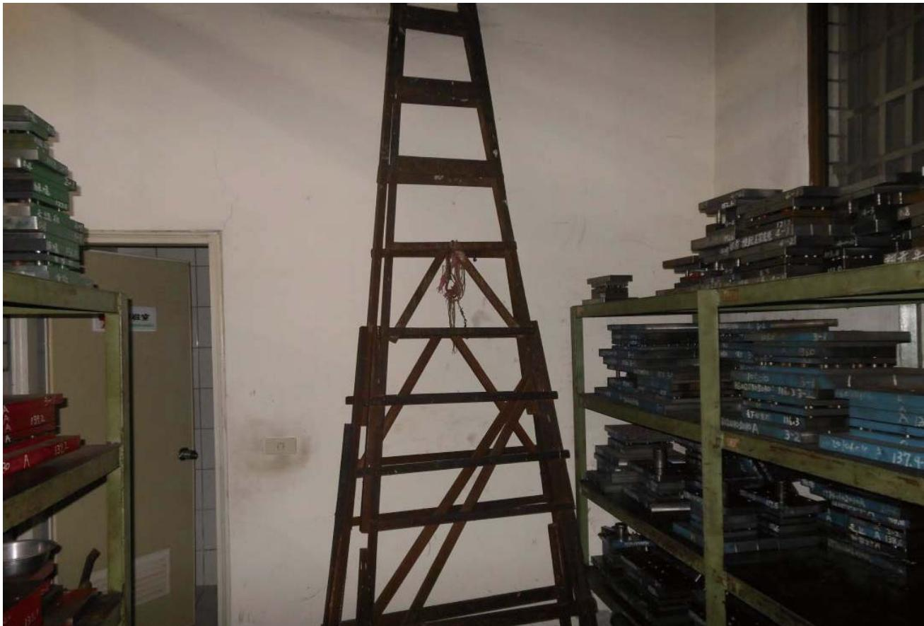
說明：對於使用之合梯，梯腳與地面之角度應在75度以內，且兩梯腳間有金屬等硬質繫材扣牢，腳部有防滑絕緣腳座套。（職業安全衛生設施規則第230條）
