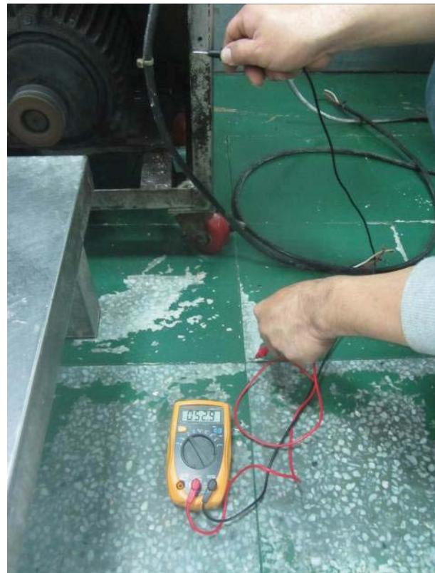
說明：未於攪拌機連接電路上設置防止感電用漏電斷路器，致發生勞工張○○感電之職業災害。(右圖為檢測漏電，其對地電壓差為 52.9V)
