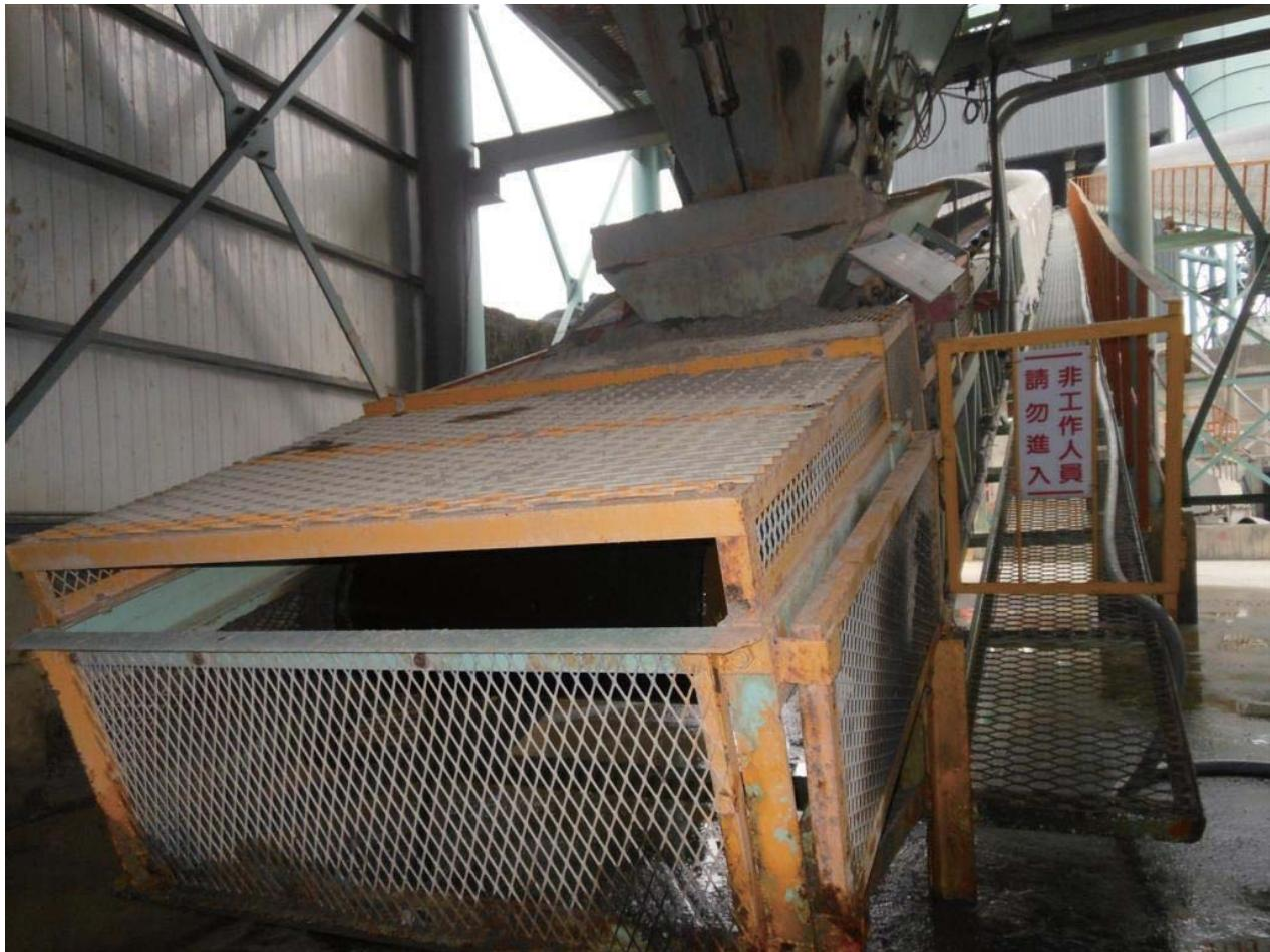
說明：輸送帶尾端滾輪已設置護罩。（職業安全衛生設施規則第43條）
