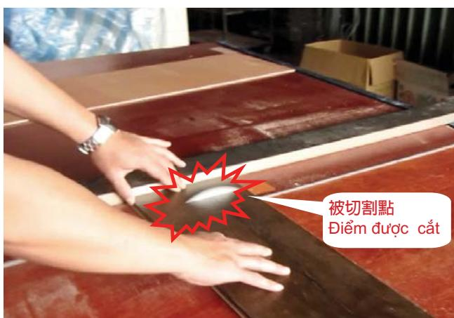
受傷者操作圓盤鋸時被割傷情況（模擬）
