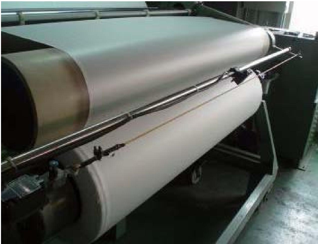
說明：滾軋機捲入點已設護圍及緊急拉繩。（職業安全衛生設施規則第78條）
