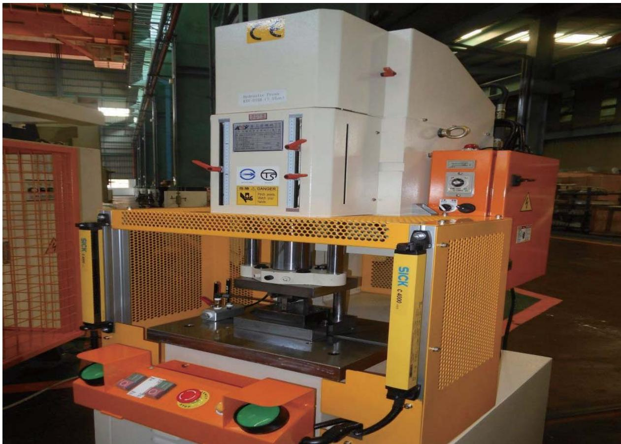
說明：衝剪機械之安全裝置。（機械設備器具安全標準第6條）
