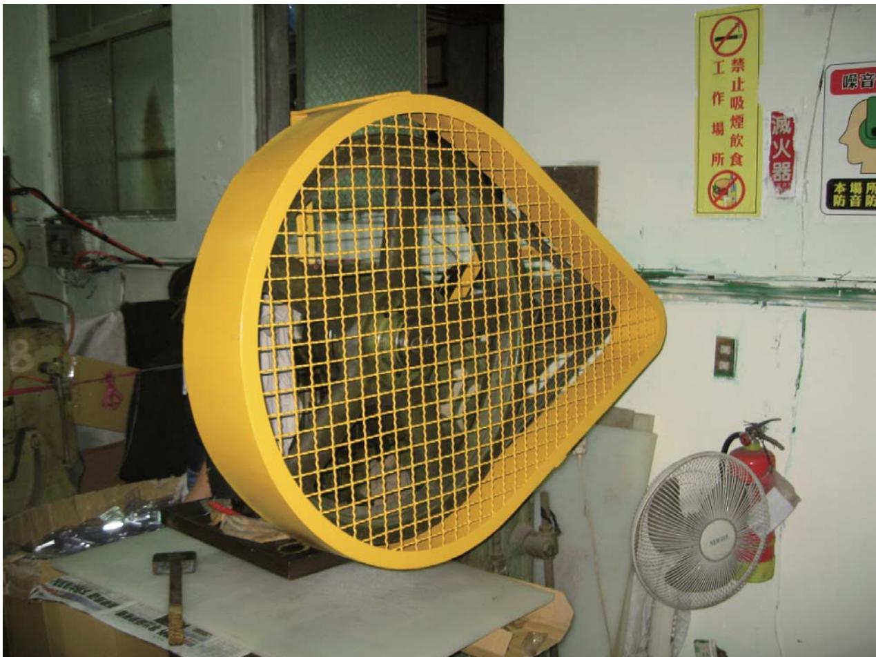
說明：衝剪機械之傳動輪、傳動帶已設置護罩。
