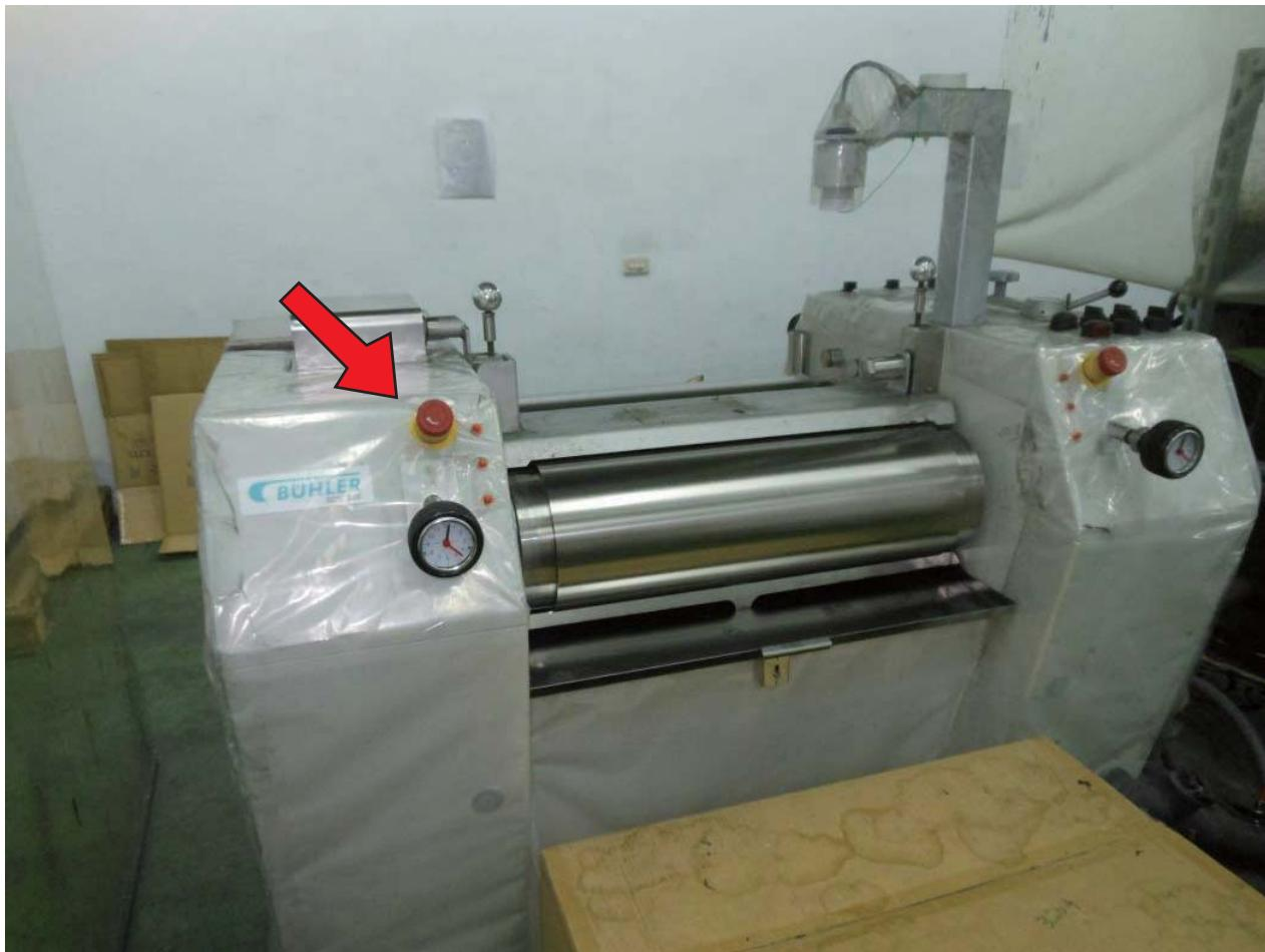
說明：滾輥機已設置易於操作之緊急制動裝置。
