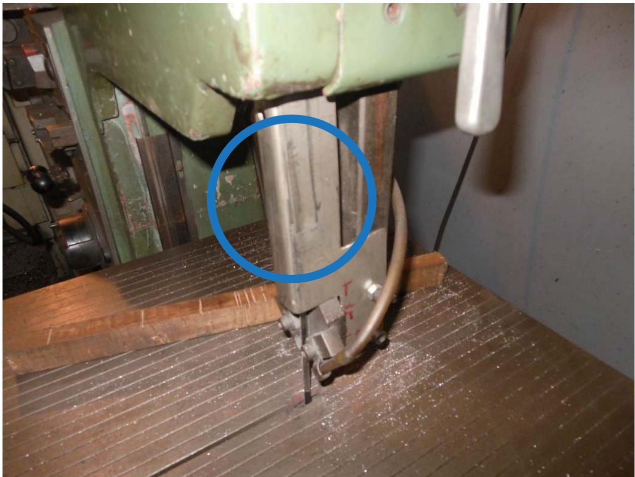
說明：帶鋸機之鋸切所需鋸齒以外之鋸齒已設置護罩。
