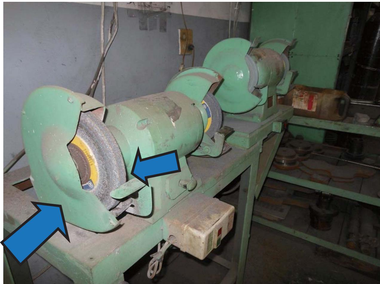
說明：研磨機之研磨輪已設側邊護蓋，工作物支架與研磨輪之間隙在3毫米以下。
