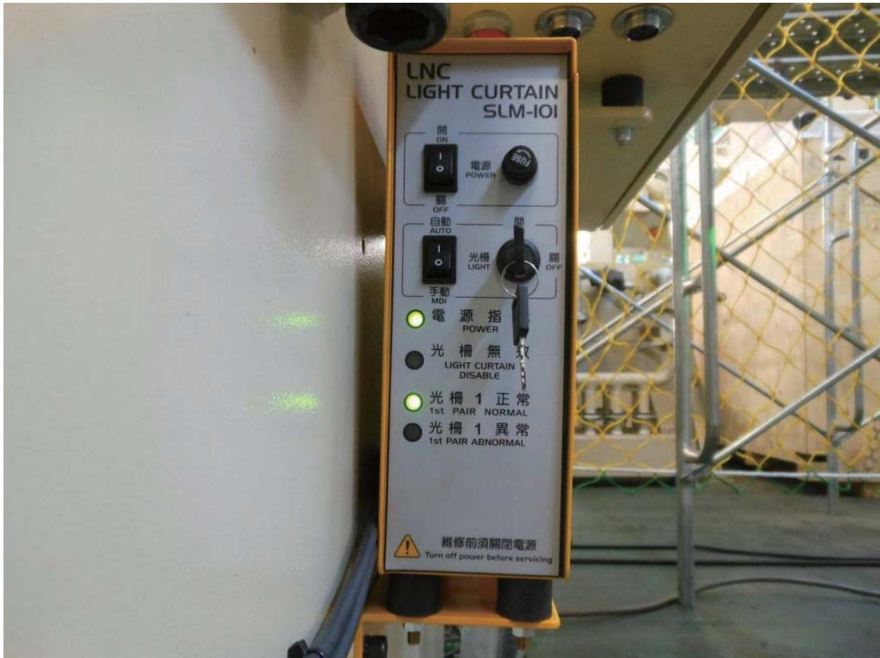
說明：衝剪機械之安全裝置應隨時保持於常開狀態。（圖為感應式安全裝置控制器）另為避免誤觸安全裝置關閉而造成勞工遭受危害，應裝置護罩或電氣連鎖裝置。
