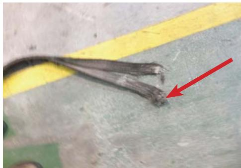
說明：吊索斷裂，未具足夠強度，致吊掛物倒塌。
