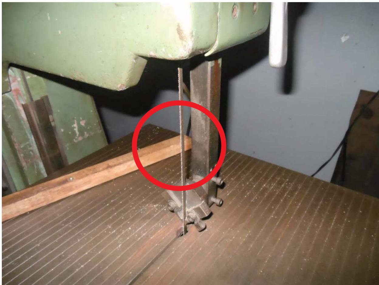
說明：帶鋸機之鋸切所需鋸齒以外之鋸齒未設置護罩。
