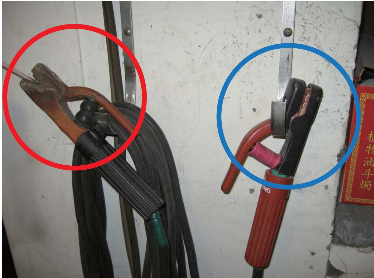
說明：電焊作業使用之焊接柄，應有相當之絕緣耐力及耐熱性。（職業安全衛生設施規則第245條）；左側焊接柄不合格（絕緣破壞）且未取下焊條。
