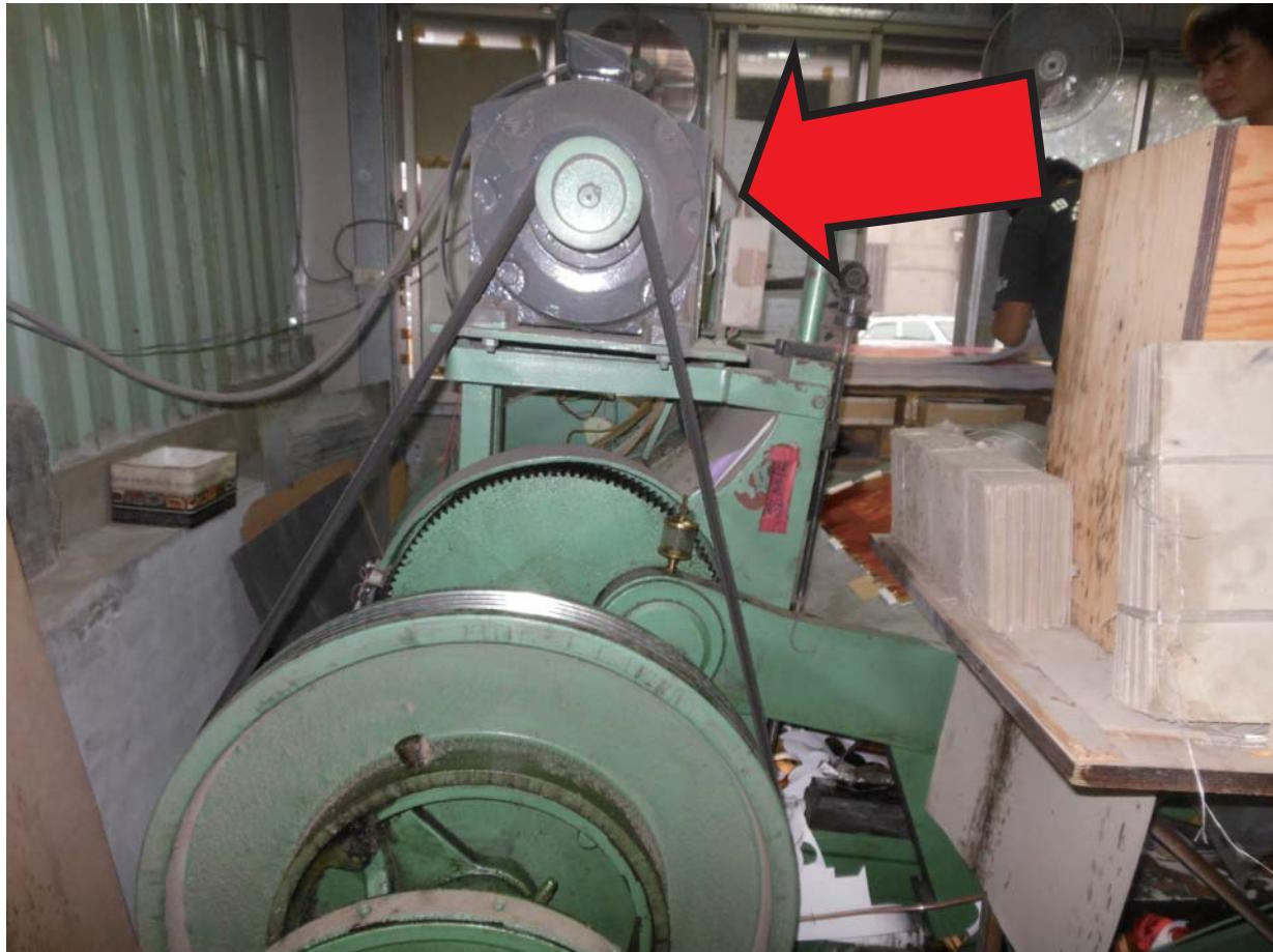
說明：對於機械之原動機、轉軸、齒輪、帶輪、飛輪、傳動輪、傳動帶等有危害勞工之虞之部分，應有護罩、護圍、套胴、跨橋等設備。
