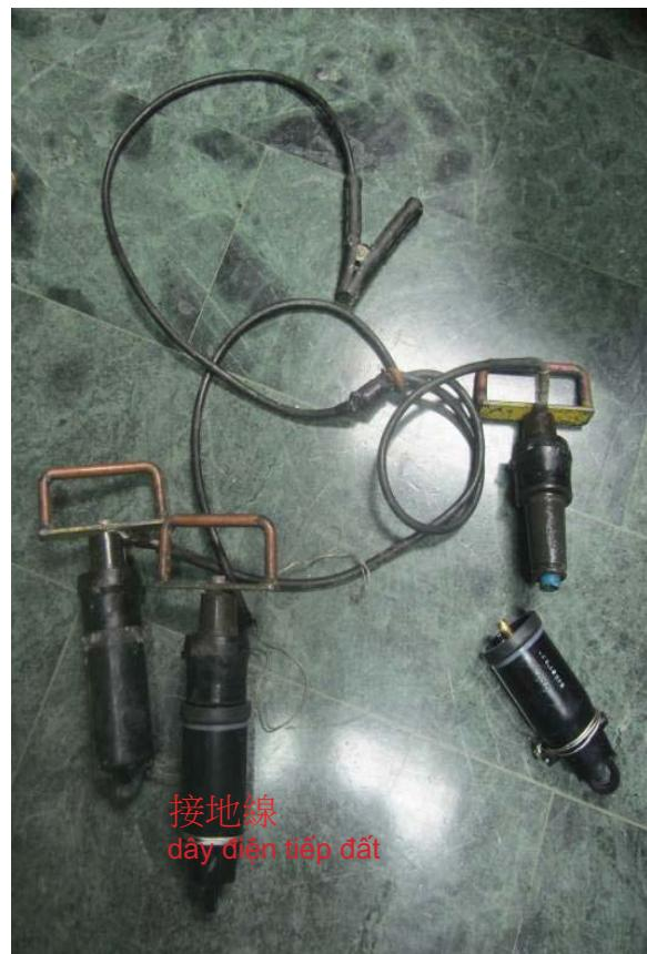
說明：陳員拉開配電室開關之肘型端頭，隨後蔣員在未使用絕緣手套，以徒手拿接地線進行接地。(右圖接地線為參考用)
