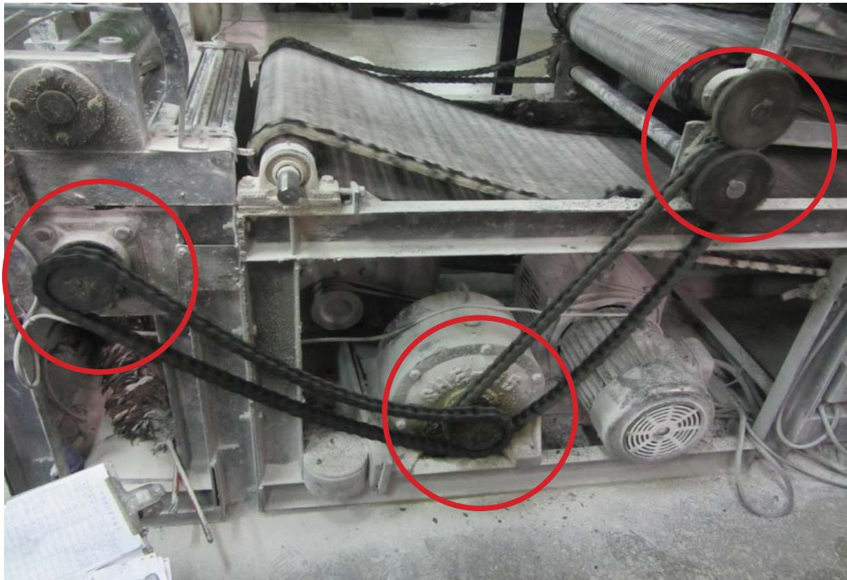
說明：對於機械之原動機、轉軸、齒輪、帶輪、飛輪、傳動輪、傳動帶等有危害勞工之虞之部分，應有護罩、護圍、套胴、跨橋等設備。
