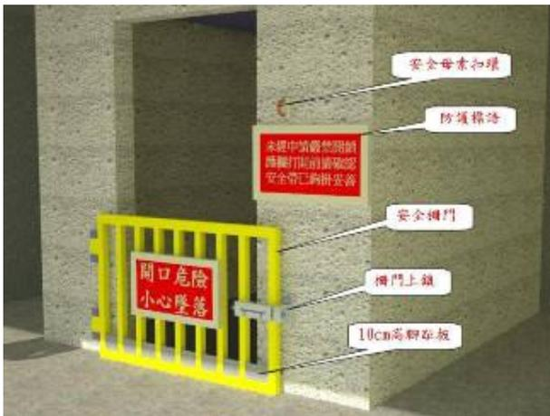
圖四、電梯開口須依規定設置高度 $\geq 90$ 公分之護欄(有上中欄杆及10公分高腳趾板)並上鎖、供勞工掛戴安全帶之扣環及防護標語。
