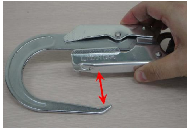
圖二、此為安全帶掛鉤無法閉合之示意照片，安全母索即從此處脫落。
