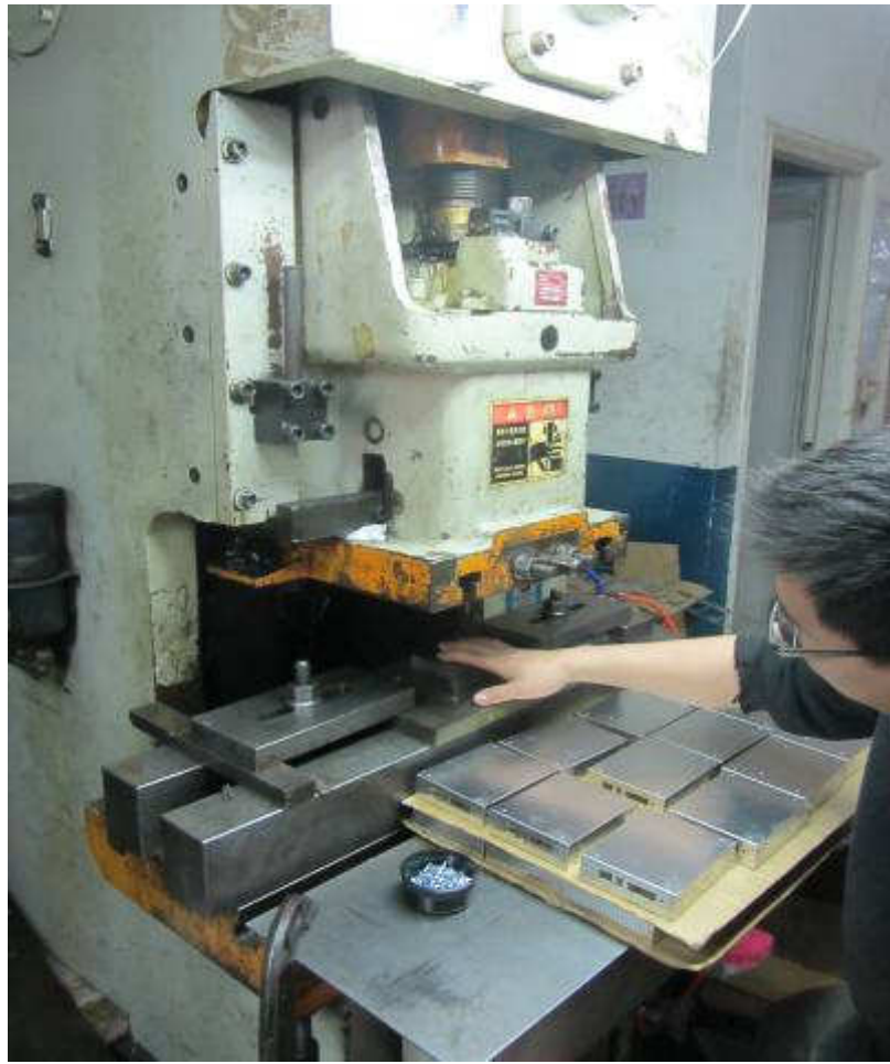
模擬受傷者操作之機臺災害發生狀況
