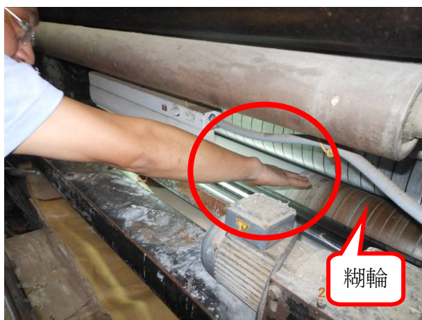
說明：發生災害現場模擬。 紅圈處為蕭員遭夾傷處。
