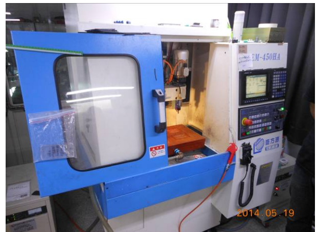
說明：CNC銑床加工機安全門無連鎖功能。
