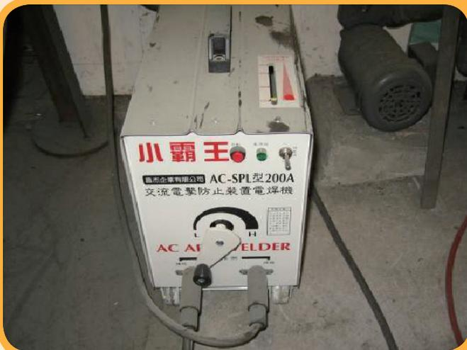
交流電焊機已設置自動電擊防止裝置。
