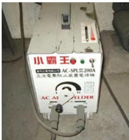
**說明**▶ 於狹小空間或鋼架等有觸及高導電性接地物之場所，作業所使用之交流電焊機，應有自動電擊防止裝置。
