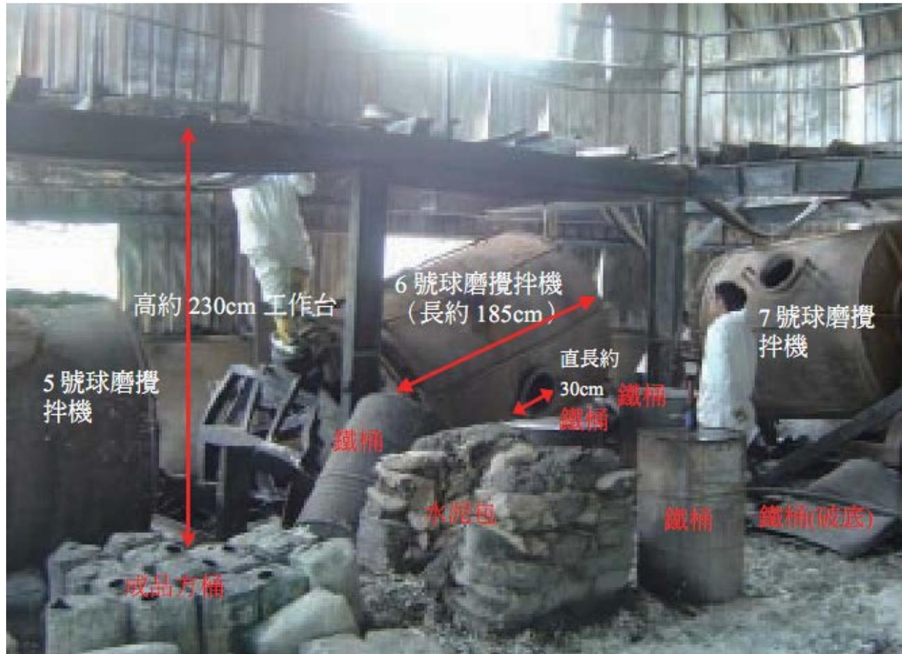
甲苯原料主要是以高壓空氣注入甲苯桶內，將甲苯擠出，以橡皮管束送至槽內，而起炸點係位於攪拌槽體內部
