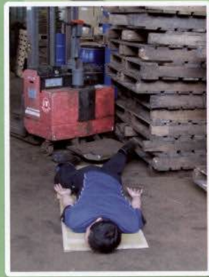
案例二： 疑似遭堆置之棧板凸出物與電動堆高機方向操縱桿，夾擠胸部造成受傷致死。 (本圖為模擬示意圖)
