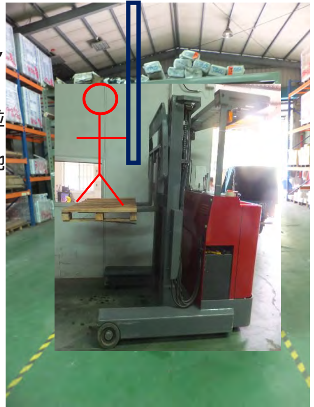
說明：人員搭載於貨叉棧板，致晃動而墜落 คนงานขึ้นไปที่บนพาเลทบนสินค้า เกิดสั่นคลอนจึงพลัดตกลงมา
