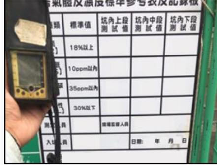
②事前以氣體偵測器測定有害氣體濃度
