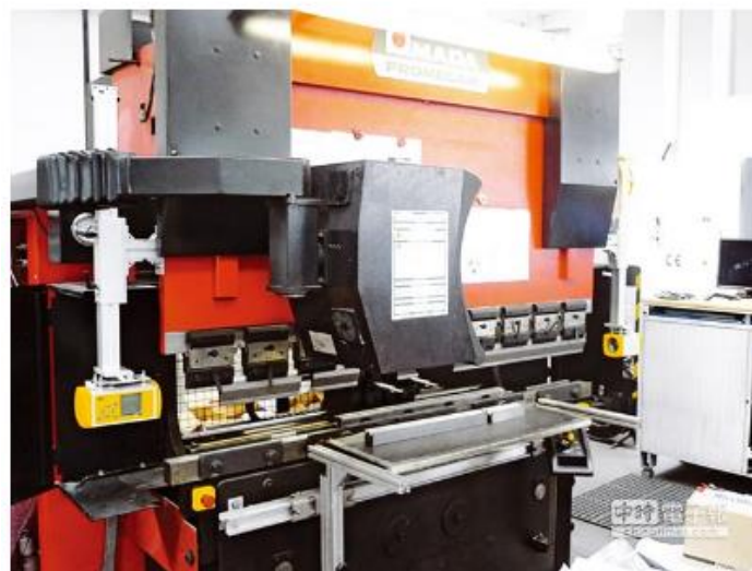
Pilz折床專用安全防護裝置PSENvp安裝實例。圖 / 業者提供
