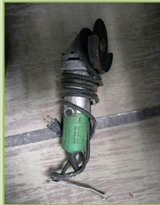
After 設置護罩防護
