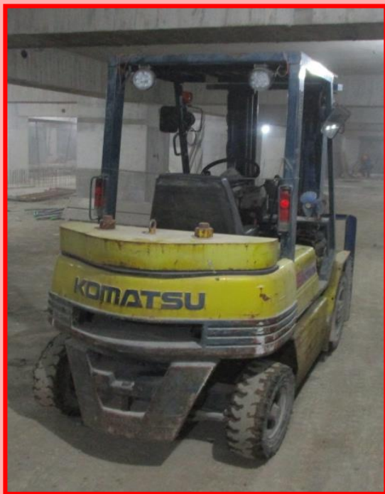
Before 未設置警報裝置
