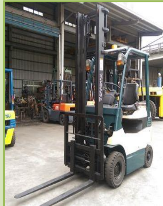
After 設置堆高機後扶架
