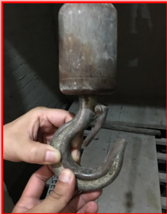
Before 未設置防滑舌片
