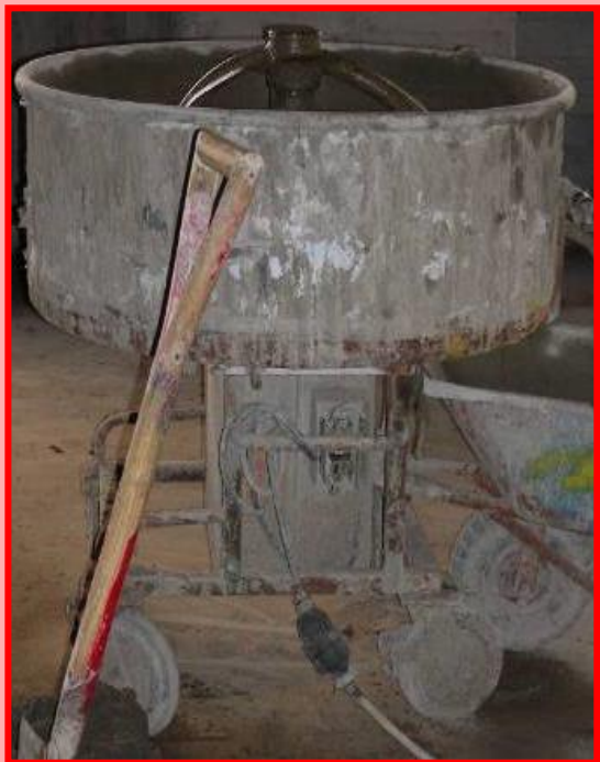
Before 未設置漏電斷路器
