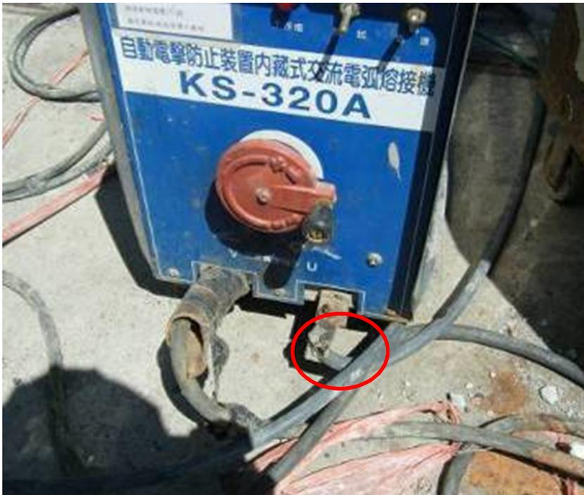
電焊機之帶電部分未設置絕緣被覆
