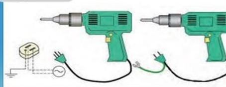
鐵具、電力系統及金屬外箱(殼)以導體與大地作良好連接，保持與大地同電位，將電流導入大地。
