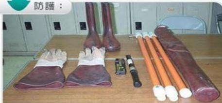
使勞工穿戴電氣絕緣用防護具或使用活線作業用器具及裝備，如穿戴絕緣手套、絕緣鞋及使用驗電工具。
