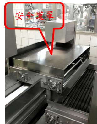
說明：現場改善（撥丸機上方設置護罩，以防止作業人員的手指不致遭旋轉金屬片夾傷）。
