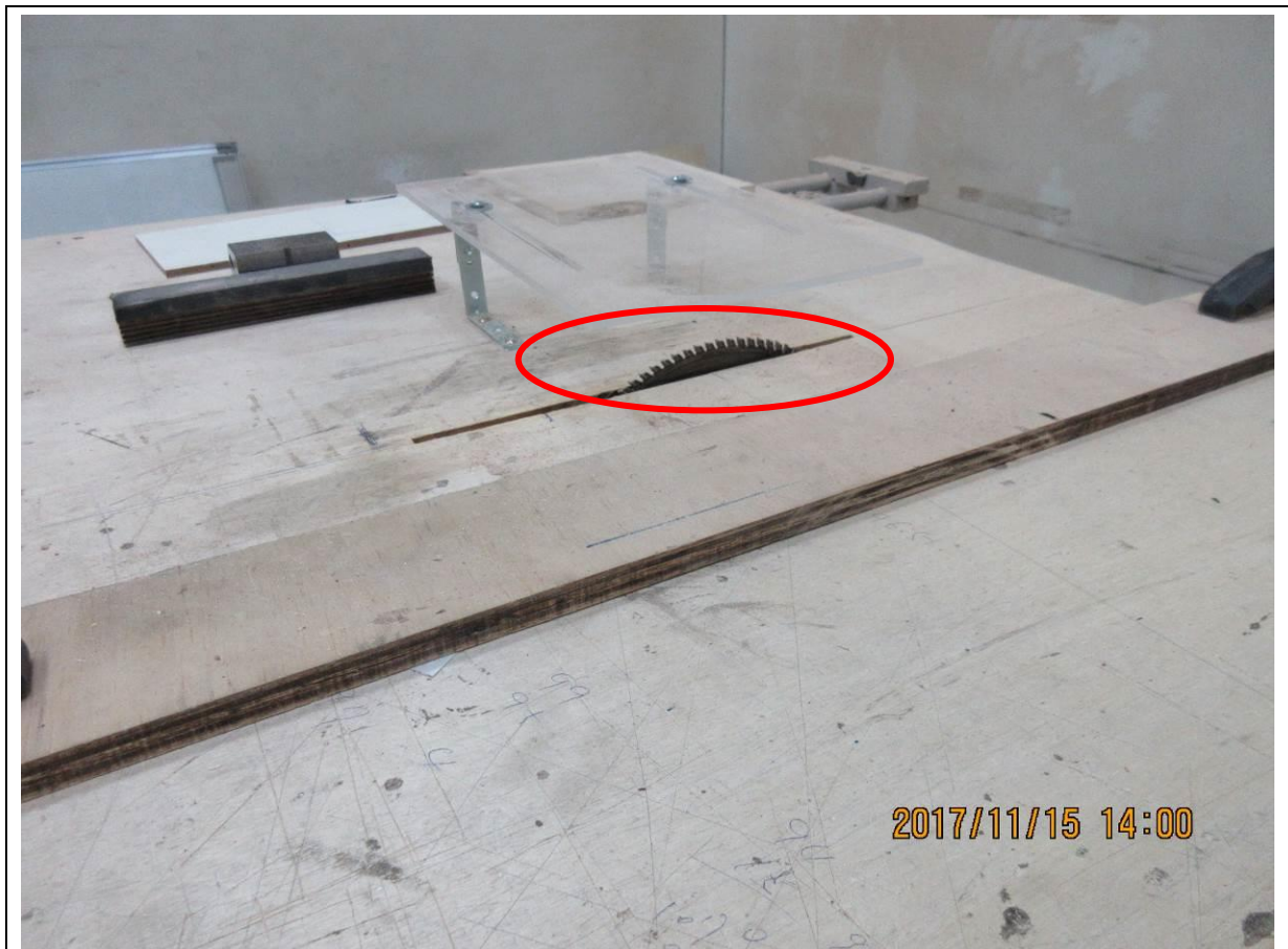
現場照片（照片中壓克力板並非鋸齒接觸預防裝置）
