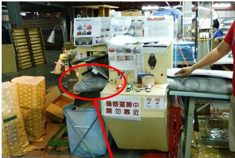
未於包裝機（捲胴作業機械）末端具有捲入危險處設置護罩、護圍或具有連鎖性能之安全門等設備。
