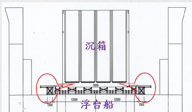
說明：於浮台船上設置束制架（紅圈），以保持沉箱堆置穩固。
