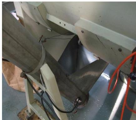
說明：塑膠出料機底口有金屬螺旋圓盤。
