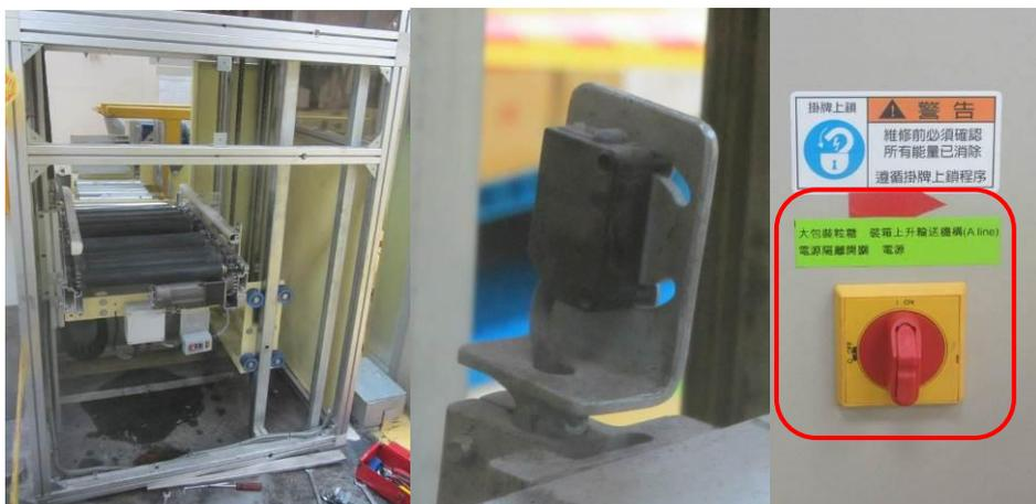
**說明:**左圖為徐員維修之升降機，維修時未將右圖電源開關關閉並掛牌上鎖，致觸及中間圖的感應器，使升降機上升，造成徐員胸部遭上升輸送機構及機臺橫桿夾傷
