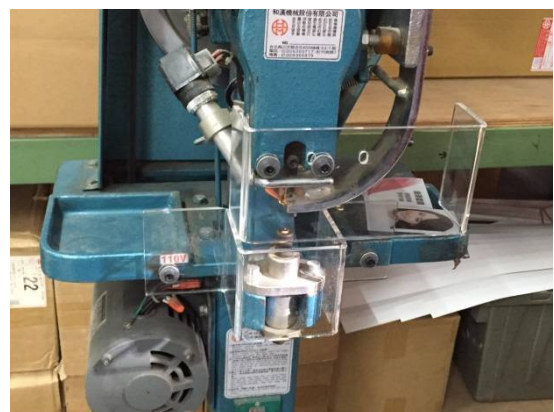
說明：模擬改善設施（於衝壓危險區域外，設置安全護圍，避免作業人員手部接近）。
