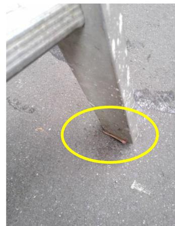
說明：現場移動梯未採取防止滑溜措施（梯腳止滑裝置已破損）。
