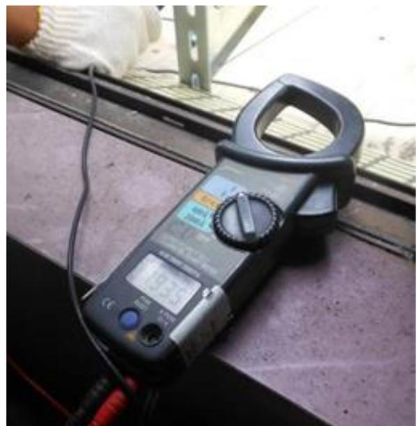
說明：測現場冷氣室外機之支架，發現冷氣室外機有漏電情形，電壓為 193.5 伏特。
