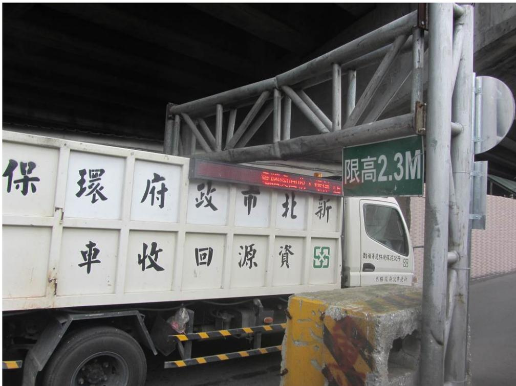
**說明：**行經產業道路入口處的限高柵欄時，李員身體已超過資源回收車駕駛室之頂部高度，致頭部遭限高柵欄撞擊，造成頸椎受傷。
