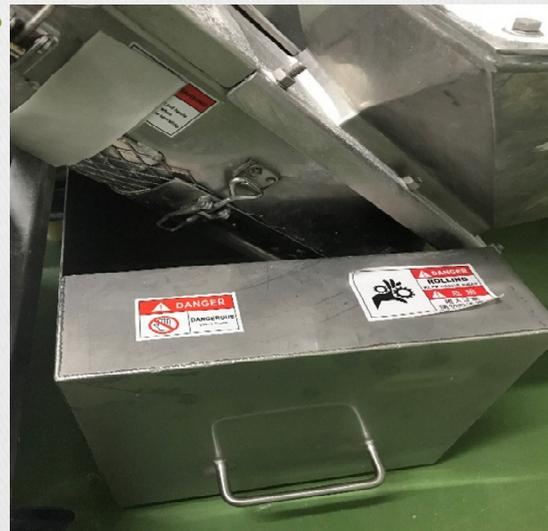
**說明：**對於退料作業已於退料口設置護罩，並以集料桶取代集料袋。
