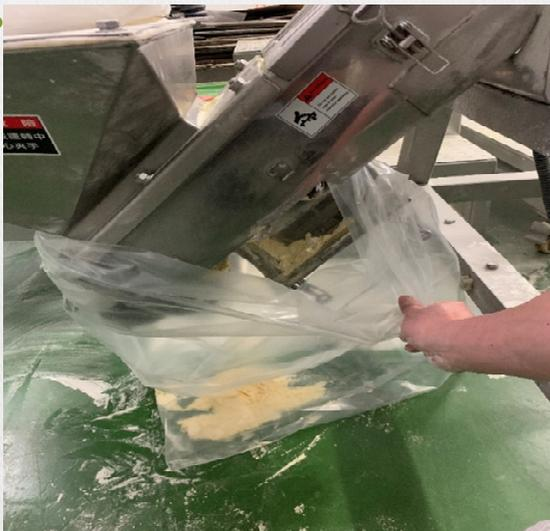
**說明：**從事自動送料混合機掃除作業時，因必須在機械運轉狀態下進行，卻未於危險之部分（即螺旋桿）設置護罩、護圍等安全設施。
