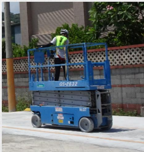
說明：於高度2公尺以上之處所進行作業時，應以架設施工架或其他方法（如高空工作車等）設置工作台。
